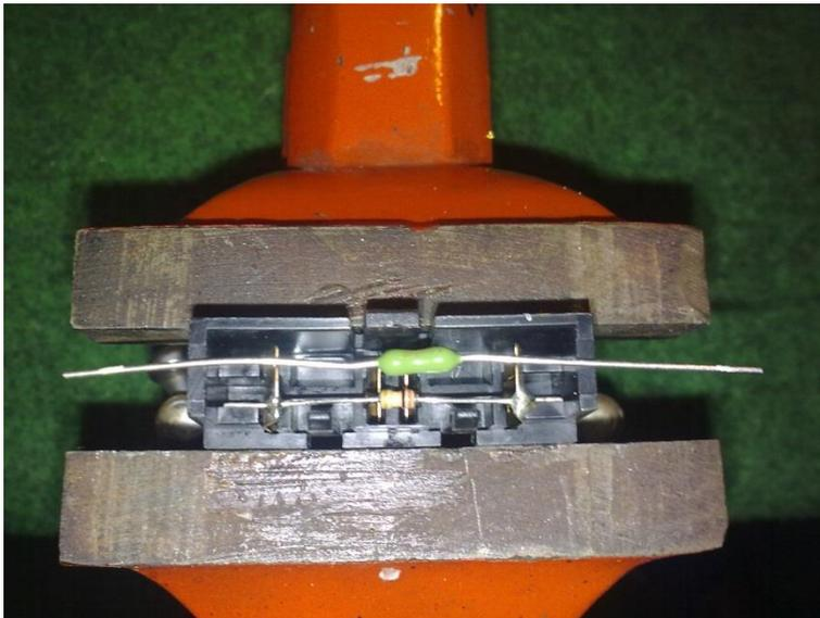
Entfernen Sie die überstehenden Enden mit einem Seitenschneider. So muss es am Ende aussehen.
