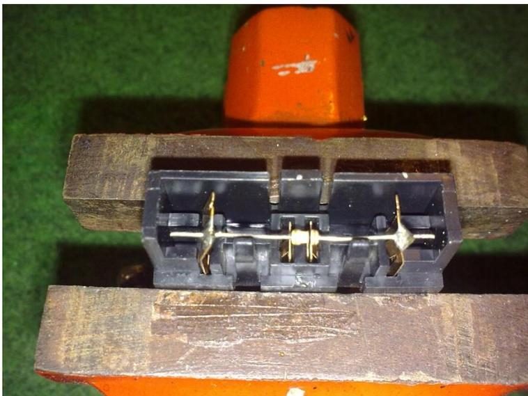
Legen Sie die Sicherung wie im Bild auf den Kontakt und löten sie an.
