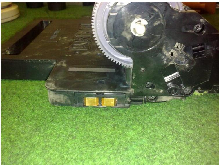
Bei dieser Ausführung befindet sich der Chiphalter seitlich an der Trommel. Um den Reset durchführen zu können entnehmen Sie zuerst die 4 Tonerkartuschen und danach den Resttonerbehälter seitlich links im Gerät. Jetzt können Sie die Trommel entnehmen und den Chiphalter mit einem Schraubenzieher aus der Halterung klicken.
